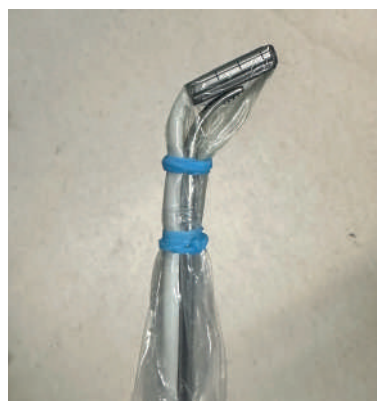
Billede 1: Arietta Hitachi LK 51 robotprobe, frekvens 3-15 mHz. Proben er på størrelse med en tandbørste, hvilket gør den ideel til transoral ultralyd.
